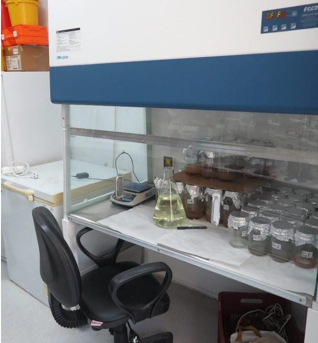
Şekil 11. İçerisine eritme çözeltisi eklenmiş ve eritme amacıyla kapalı kabinde beklemeye alınmış örnekler
