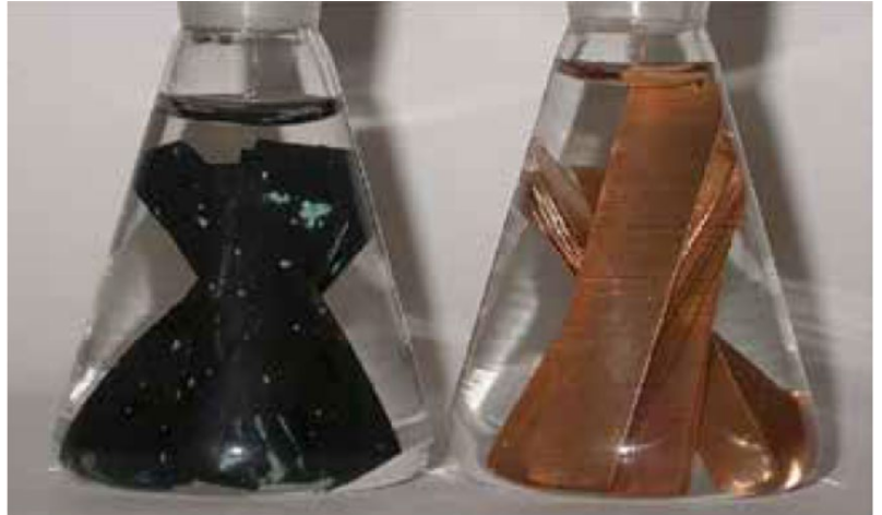
圖十七 銅暴露於室溫蒸餾水之中達 15 年後的狀況。腐蝕所產生的氫氣可以從左邊燒杯中逸散，但無法自右邊燒杯中逸散。兩個燒杯一開始的水量都是相同的。
