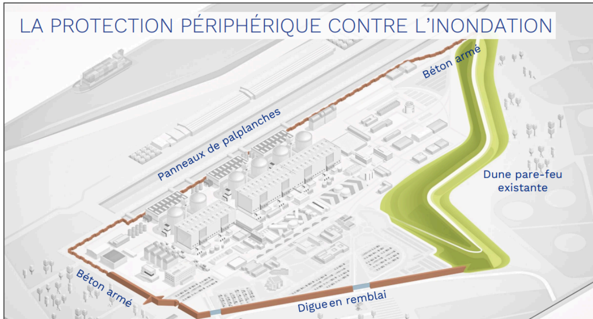
↑ Figure 5 : La protection périphérique contre l'inondation de la centrale de Gravelines. (Source : Document EDF de présentation de la protection périphérique contre l'inondation (PPINO) de la centrale de Gravelines)
