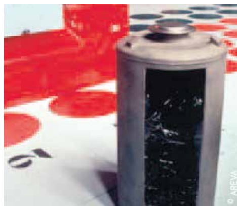
Figure 2 - Conteneur métallique de déchet HA vitrifié
