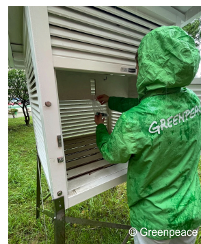
画像 1: グリーンピースのスタッフが温度測定のために、学校の百葉箱に温湿度データロガーを設置している様子
