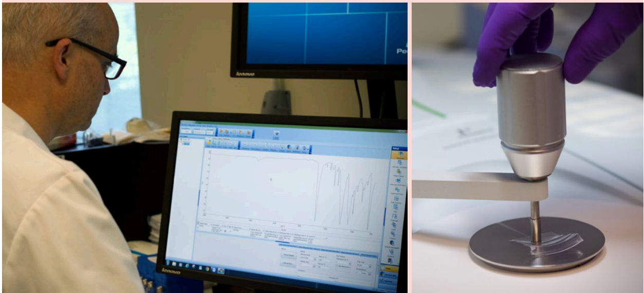
フーリエ変換赤外分光法（FT-IR）による各チェーンのプラスチックおよび紙カップ素材の特定
