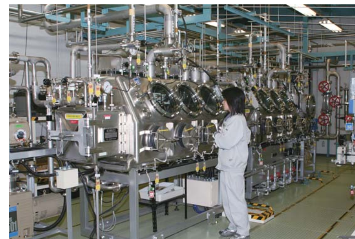
化学反応変化試験設備 (EDAS) 地下環境を模擬した化学反応試験装置 写真提供：日本原子力研究開発機構
