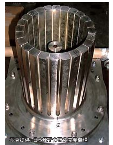
日本原子力研究開発機構 CCIM方式アニオン型 溶融塩電解槽 試作した乾式再処理プロセスの 溶融塩電解槽
