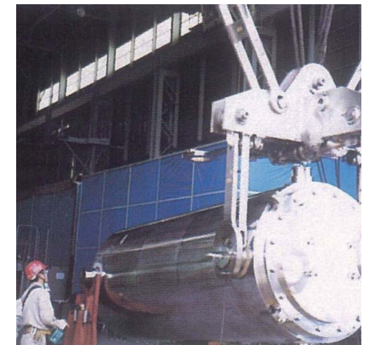
東京電力殿 固体廃棄物構内輸送容器 発電所等構内で放射性物質を移送する輸送容器
