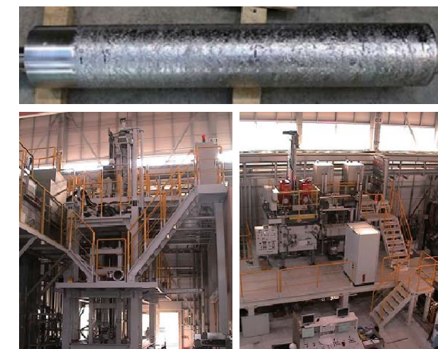
高耐食性合金EHPのインゴットと製造設備 左:CCIM 溶融炉 右:EB 溶融炉
