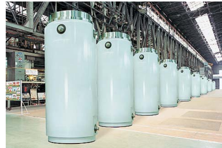
東京電力 殿 TN24 型貯蔵容器 使用済燃料を貯蔵するための貯蔵容器
