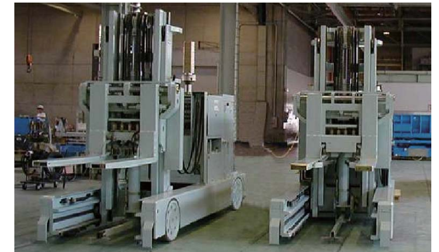
日本原燃 (株) 殿 第2低レベル廃棄物貯蔵設備 自動フォークリフト 放射性廃棄物 (ドラム缶、ボックスパレット、角型容器) を自動搬送する設備
