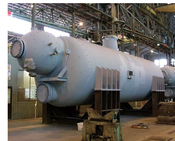
湿水分離加熱器(MSR) 高圧タービンと低圧タービンの間に設置される大型熱交換器
