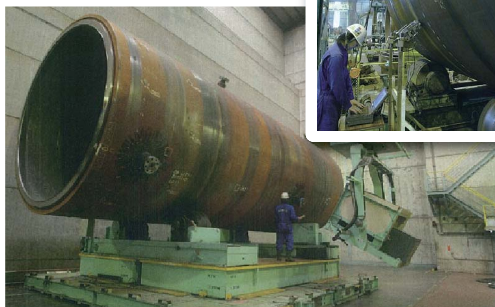
神戸製鋼所：高砂製作所 放射線透過検査装置 (ライナック：9Mev)
