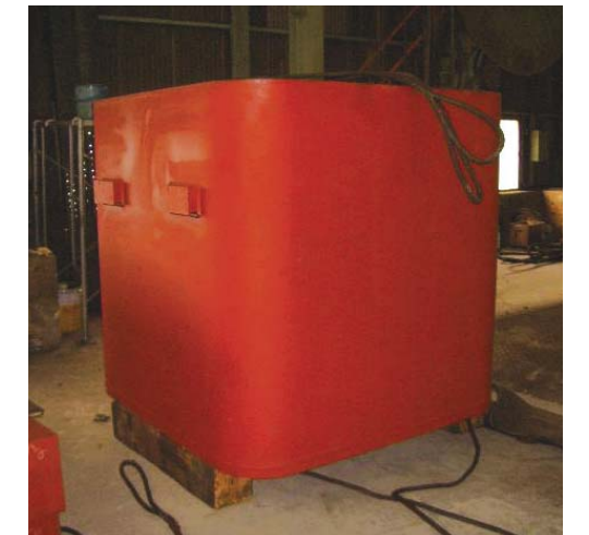
試作したLLW向け溶接容器胴部
