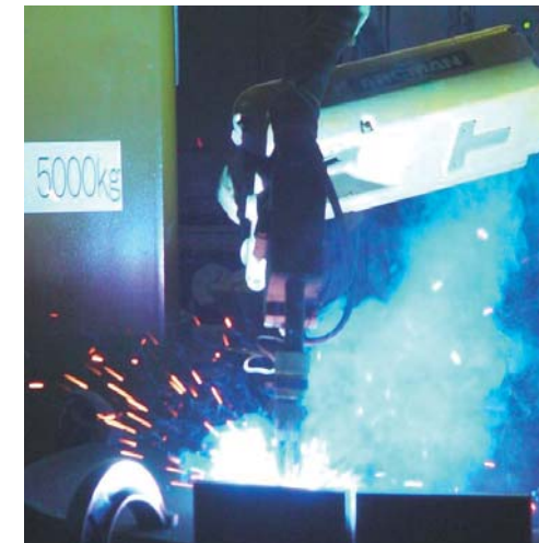
炭素鋼容器蓋部の遠隔自動溶接試験 (MAG法)
