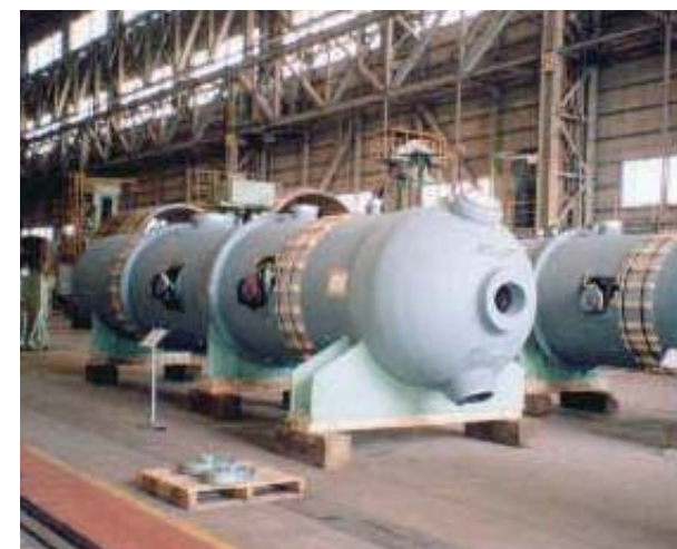
給水加熱器(FWH) 給水を加熱するために設置される熱交換器
