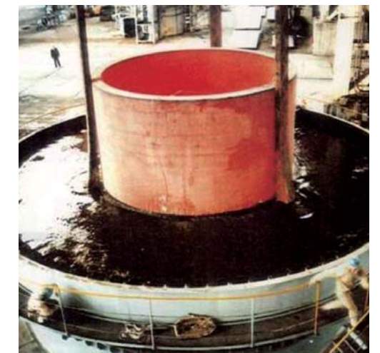
シェル(熱処理中) 原子炉圧力容器・蒸気発生器の胴部となるリング状鍛造部材の熱処理技術
