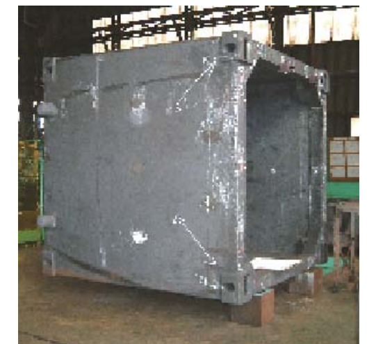
試作したLLW向け鋳造処分容器本体
