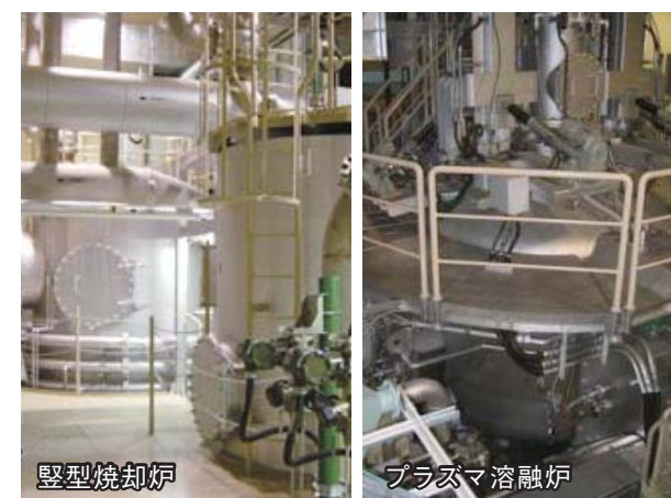
縦型焼却炉 プラズマ溶融炉 難燃物の焼却炉 雑固体の溶融炉
