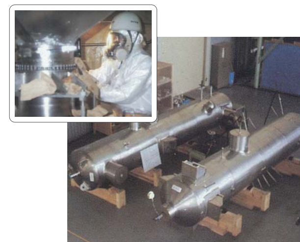
日本原子力研究開発機構 酸回収蒸発缶(Ti-5Ta製)と取替工事 再処理工場の取替用高耐食性機器とその取替工事 写真提供:日本原子力研究開発機構
