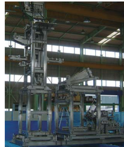
日本原燃 (株) 殿 / (株) 東芝殿 BP棒減容装置 バーナブルポイズン (BP) をプール中で切断する設備
