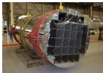
アメリカ TRANSNUCLEAR, Inc. 殿 NUHOMS 型貯蔵キャニスタ内部構造 海外における使用済燃料乾式貯蔵の ための貯蔵キャニスタ
