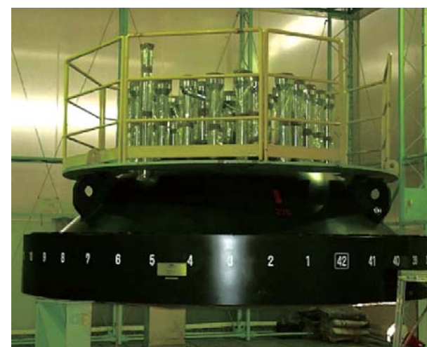
PWR 交換用上蓋 高経年化した PWR 原子炉の交換用の上蓋
