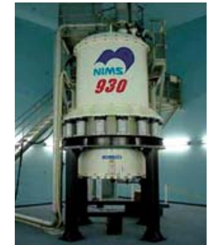
(独)物質・材料研究機構殿向け 高分解能 NMR マグネット 2004年に世界最高磁場を達成
