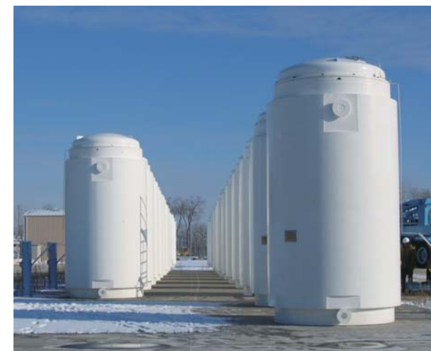
アメリカ TRANSNUCLEAR, Inc. 殿 TN40 型輸送貯蔵容器 海外における使用済燃料の貯蔵容器 写真提供: Xcel Energy
