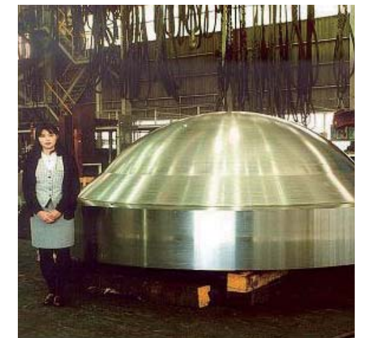
クロージャーヘッド 原子炉圧力容器の一体化鍛造上蓋
