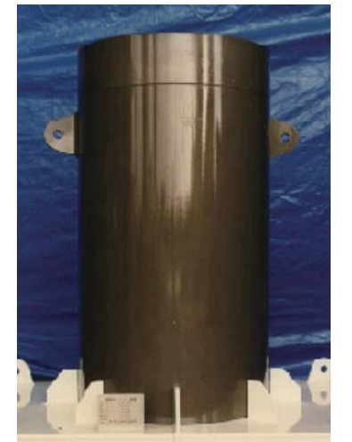
試作したHLW向け処分容器
