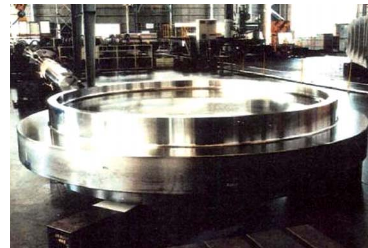
チューブシート 蒸気発生器の伝熱細管が溶接固定される円板状鍛造部材
