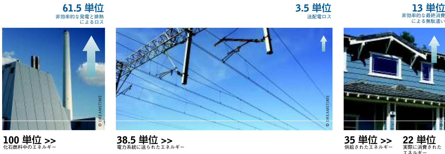
図6 投入エネルギーの3分の2以上が無駄となる大規模集中型エネルギーシステム
