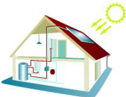
図35 平板型太陽熱温水システム
