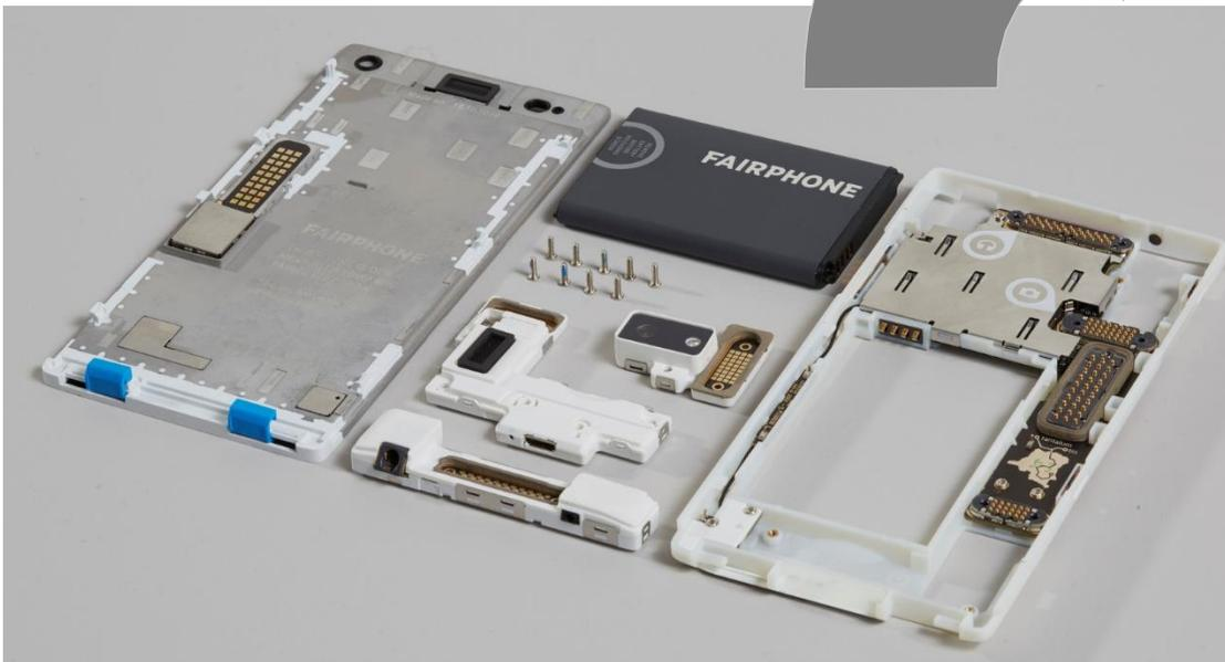
モジュール方式と修理のしやすさに注力した、より長持ちする製品デザイン
